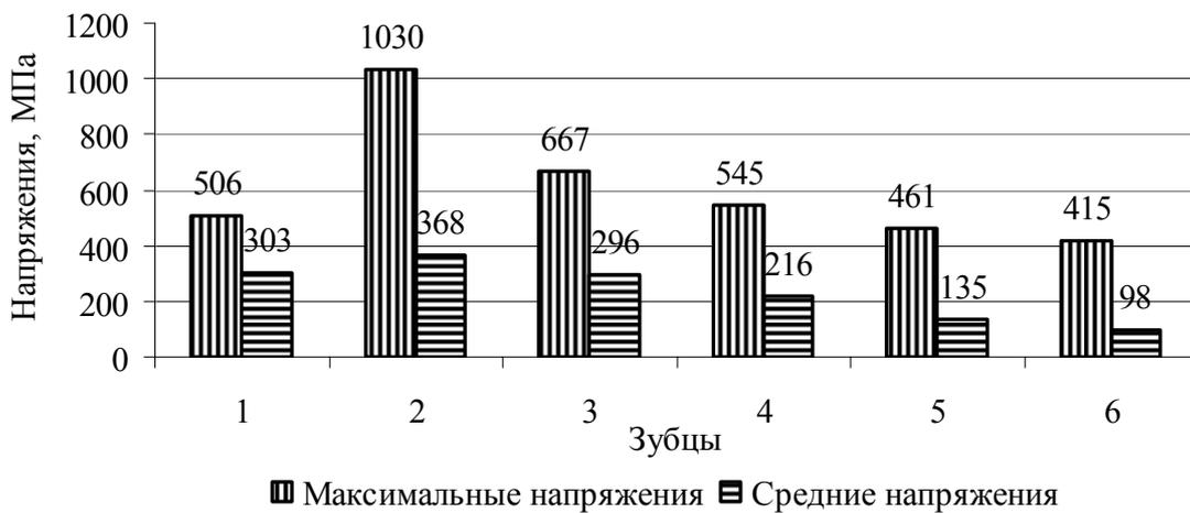
Рис. 6 – Вариант № 2. Распределение напряжений по расчетным сечениям хвостовика
