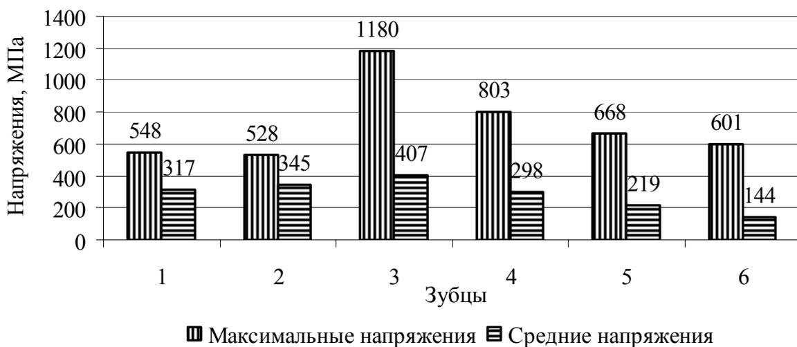
Рис. 7 – Вариант № 3. Распределение напряжений по расчетным сечениям хвостовика
