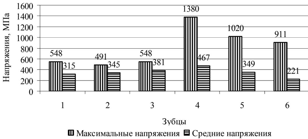
Рис. 8 – Вариант № 4. Распределение напряжений по расчетным сечениям хвостовика
